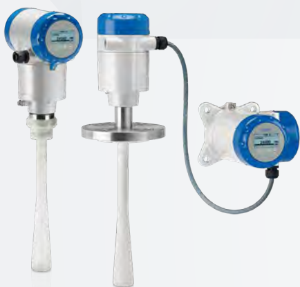
OPTIWAVE 5200 C/F 10 ГГц радарное FMCW устройство для жидкостей в резервуарах хранения и технологических емкостях
